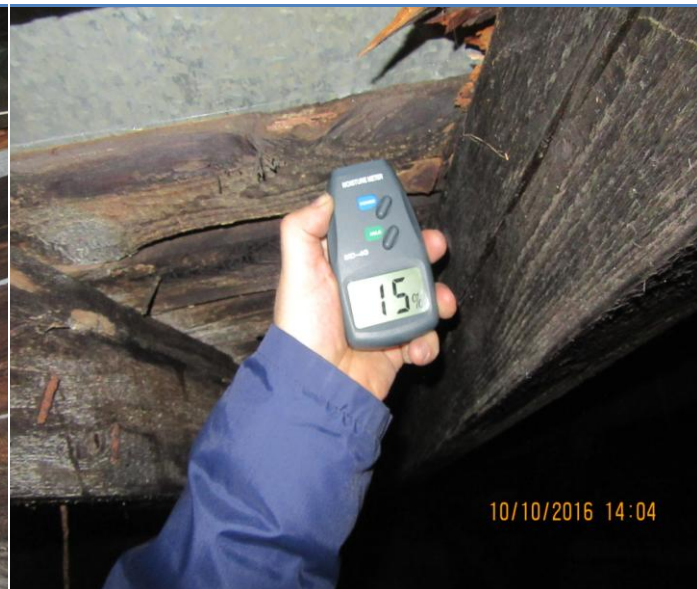
20.att.Bojātās sateces vietas koksnes virsmas mitruma mērījums.
