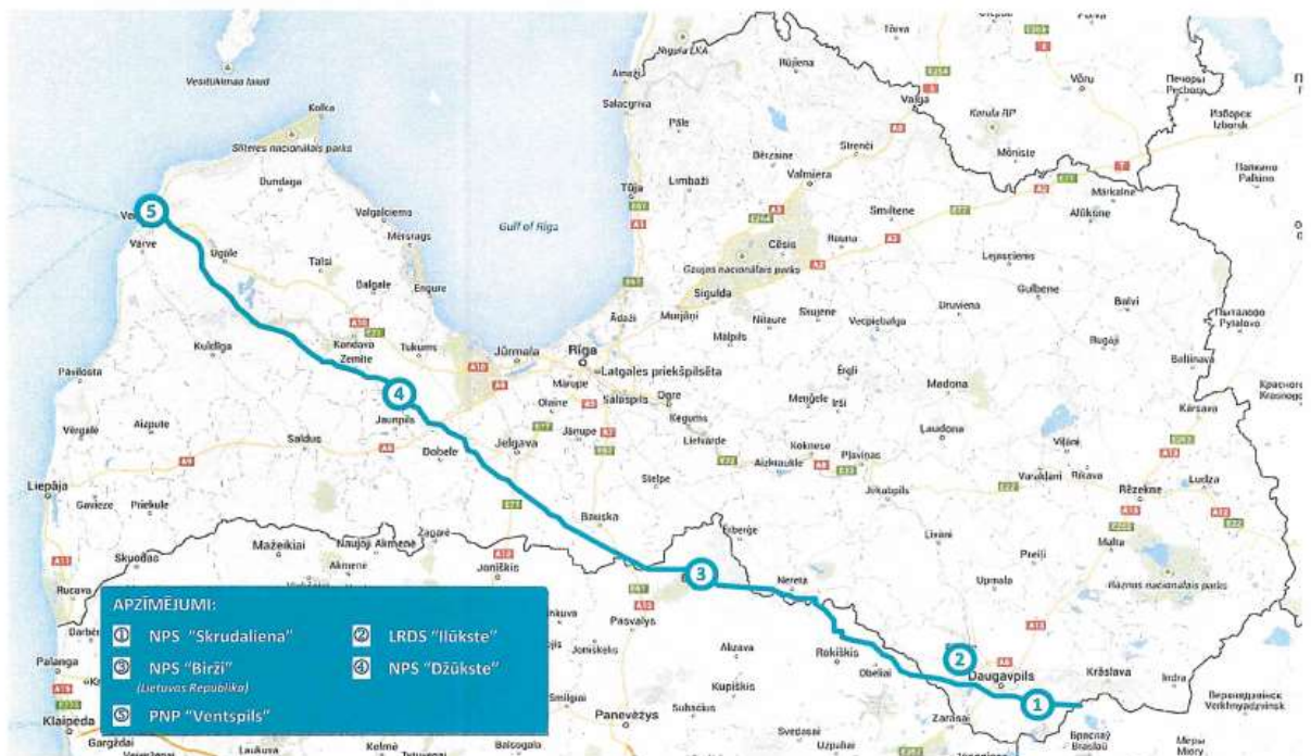
20. attēls. Maģistrālā cauruļvada shēma un Latvijas republikas un Lietuvas republikas teritorijā esošo LRDS, NPS un PNP atrašanās vietas [LatRosTrans rīcības plāns noplūžu gadījumos 2020]
