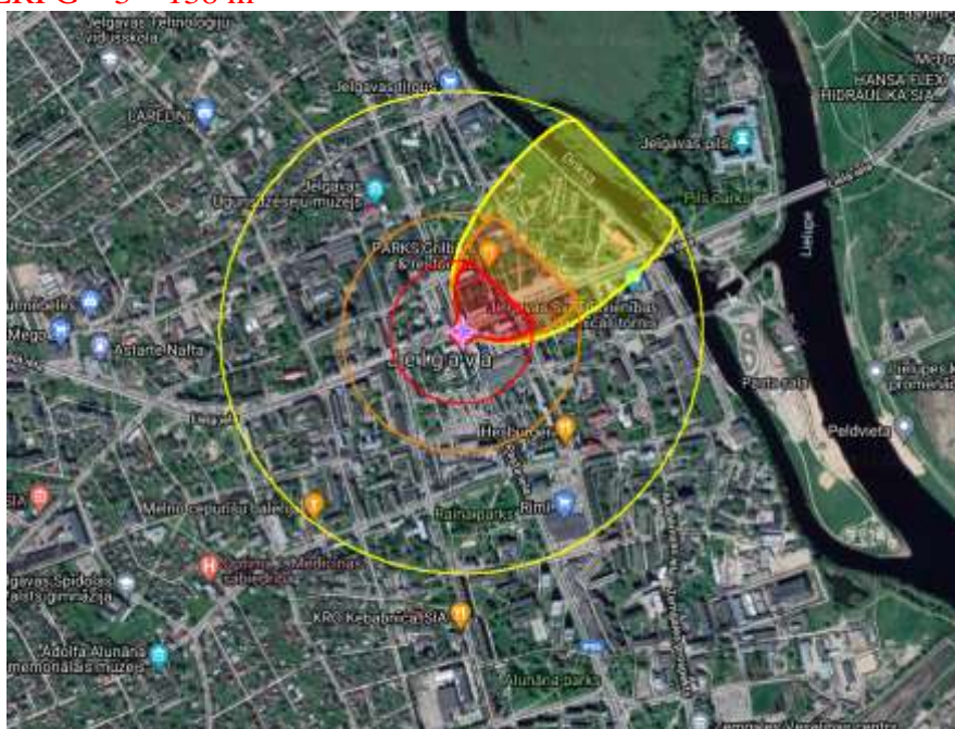
29. attēls. Benzīna noplūdes no autocisternas toksisko tvaiku izplatība
