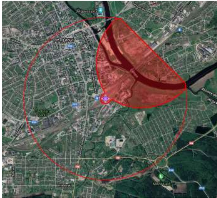
44. attēls. Benzīna noplūdes no vagoncisternas toksisko tvaiku izplatība
