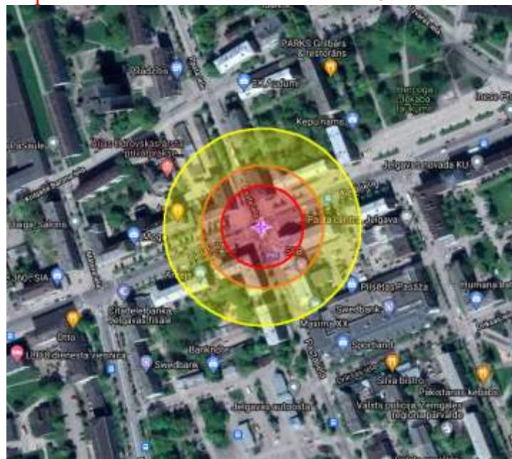
36. attēls. Siltumstarojuma zona
