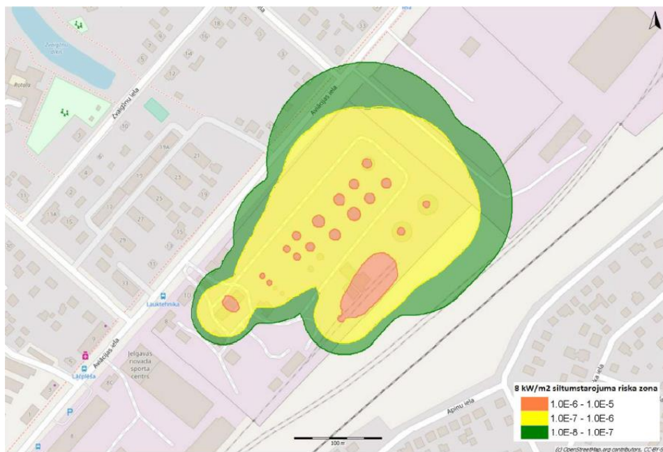
22. attēls. Siltumstarojuma zonas SIA “DANFORT” Jelgavas naftas bāzē [SIA “DANFORT” Jelgavas naftas bāzes rūpniecisko avāriju riska novērtējums, SIA “PSI” risks un audīts, 2017]
