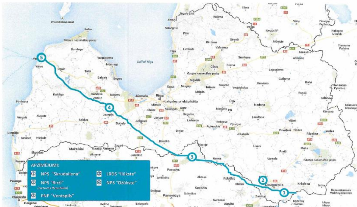
32. attēls. Maģistrālā cauruļvada shēma un Latvijas republikas un Lietuvas republikas teritorijā esošo LRDS, NPS un PNP atrašanās vietas [LatRosTrans rīcības plāns noplūžu gadījumos 2020]
