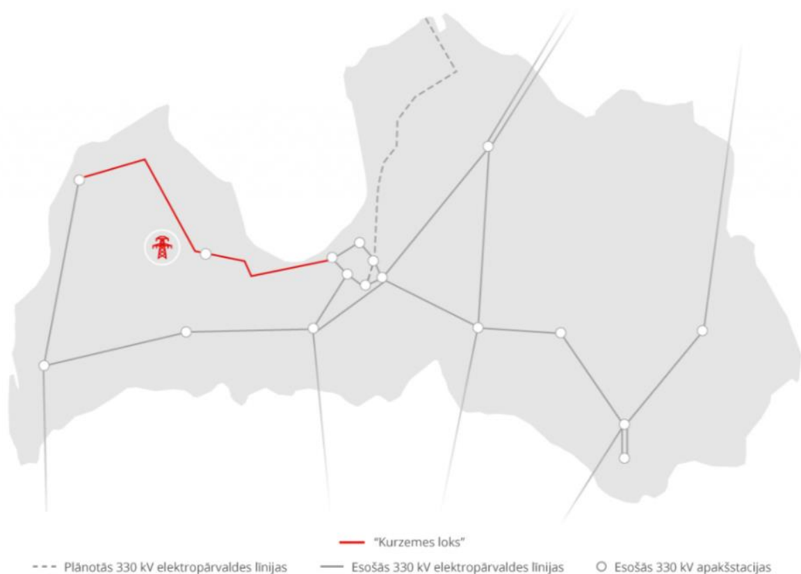
25. attēls. Esošās 330 kV augstsprieguma līnijas Latvijā [AS “Augstsprieguma tīkli”]
