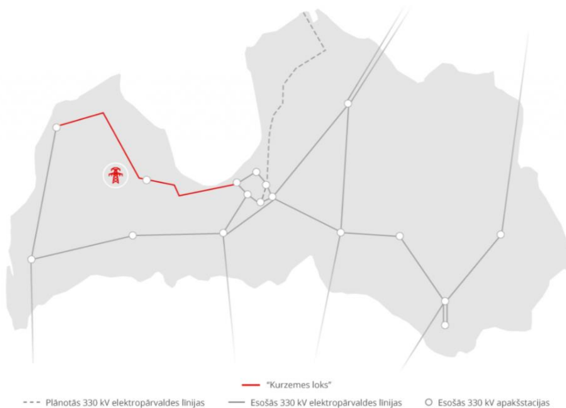
38. attēls. Esošās 330 kV augstsprieguma līnijas Latvijā [AS “Augstsprieguma tīkli”]
