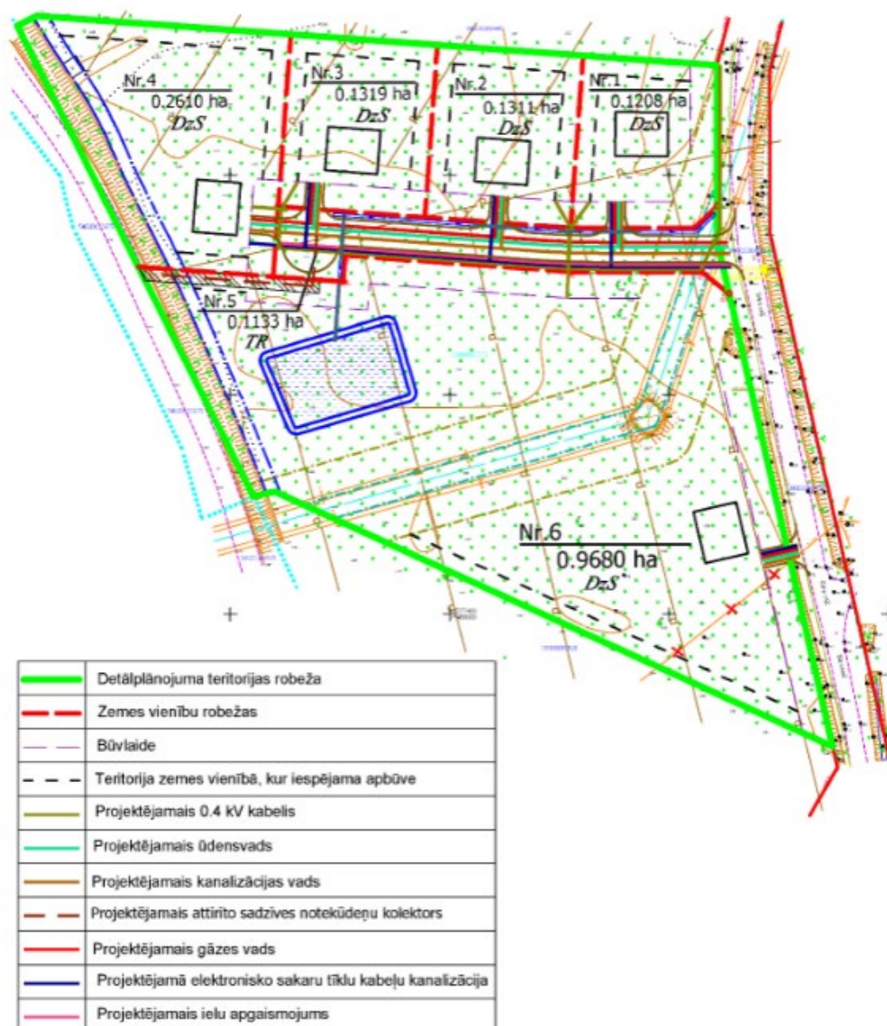
Attēls Nr. 13. Inženierkomunikāciju shēma. Inženierkomunikāciju risinājumus skatīt Grafiskās daļas plānā Nr. 3 “Inženierkomunikāciju plāns”
